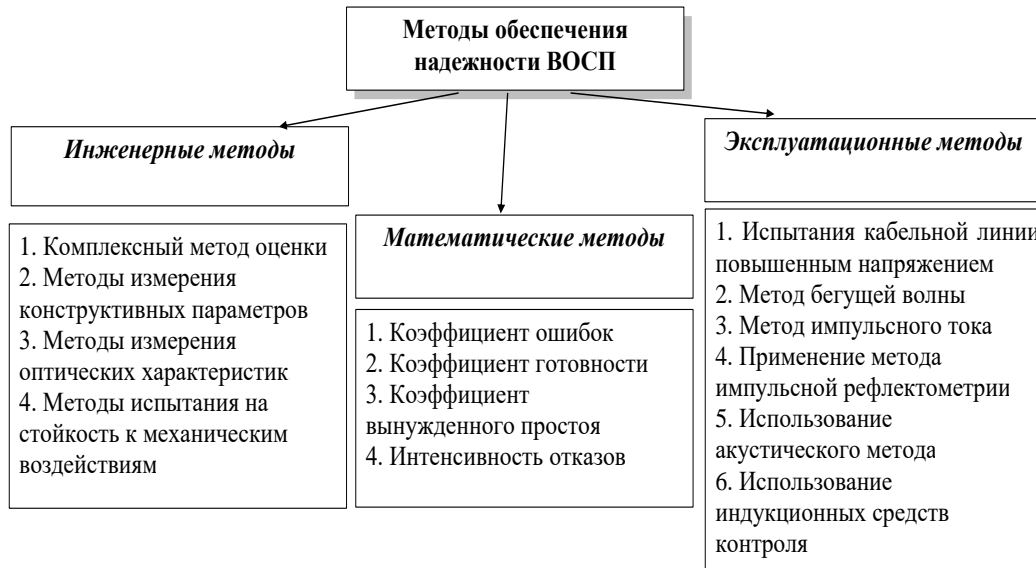
Рис. 2. Классификация методов обеспечения надежности ВОСП
