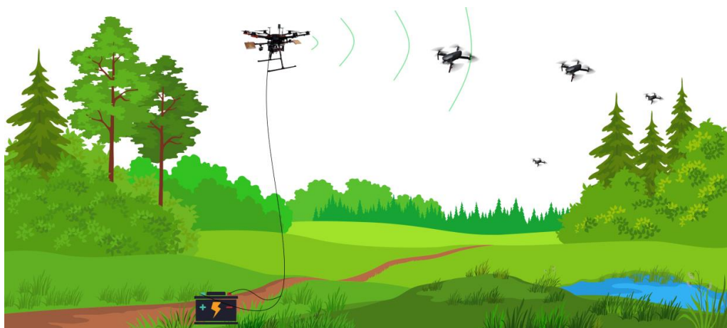
Рис. 1. Принцип обнаружения низколетящих дронов при помощи БАС с РЛС на борту
