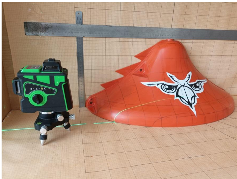
Рис. 2. Измерение профиля лазерным указателем уровня Zitrek
