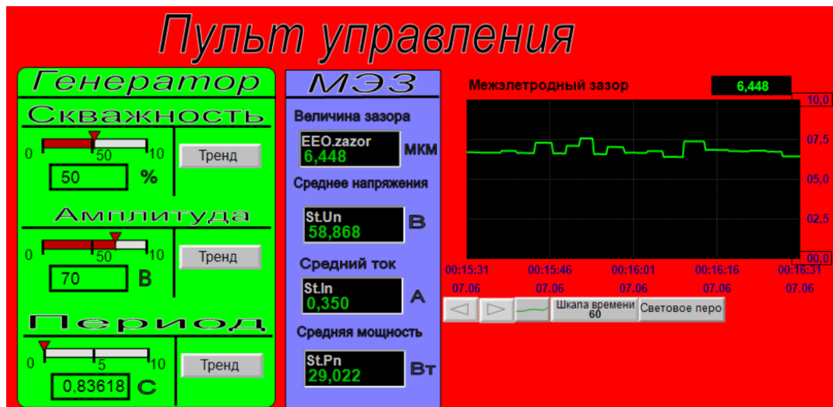
Рис. 1. Пульт управления и диспетчеризации электроэрозионного станка
