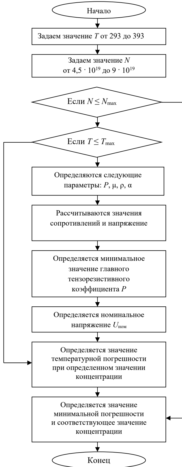
Рис. 3. Блок-схема алгоритма нахождения численного значения оптимальной концентрации примеси
